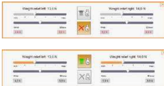
Obr. č. 15: Hmotnostní odlehčení nahore: není aktivováno hmotnostní odlehčení (standardní poloha) dole: aktivované hmotnostní odlehčení
