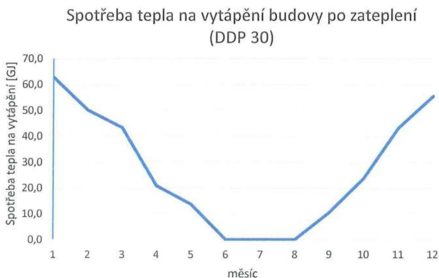
Obr. 3: Předpokládaná spotřeba tepla na vytápění zateplené budovy
