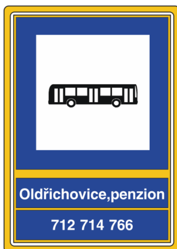
Obrázek č. 4: Vzor zastávkové hlavy doplněné o tzv. pomocný rám
