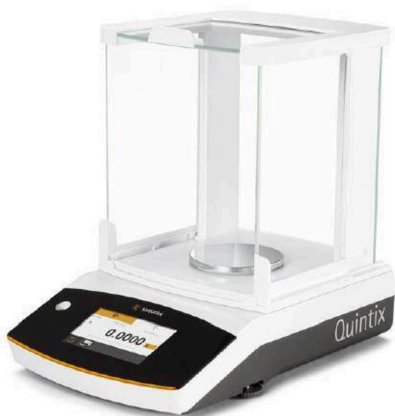
Design vah Quintix s nejmenším zobrazitelným dílkem 0,1 mg
