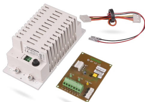
BP12-18 slouží pro napájení libovolného zařízení zálohovaným stejnosměrným napětím 12V. Tento zdroj lze umístit do boxu PLV-CP-L. V tomto boxu lze použít akumulátor 7 Ah - 18 Ah (lze použít akumulátor až 26Ah ve vlastním boxu).
