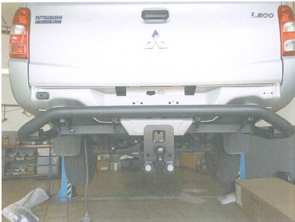
Homologovaný adaptér s ISO koulí nasazený v ARB zadním nárazníku.
