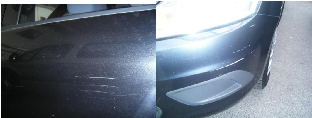
- Poškození laku - škrábance
