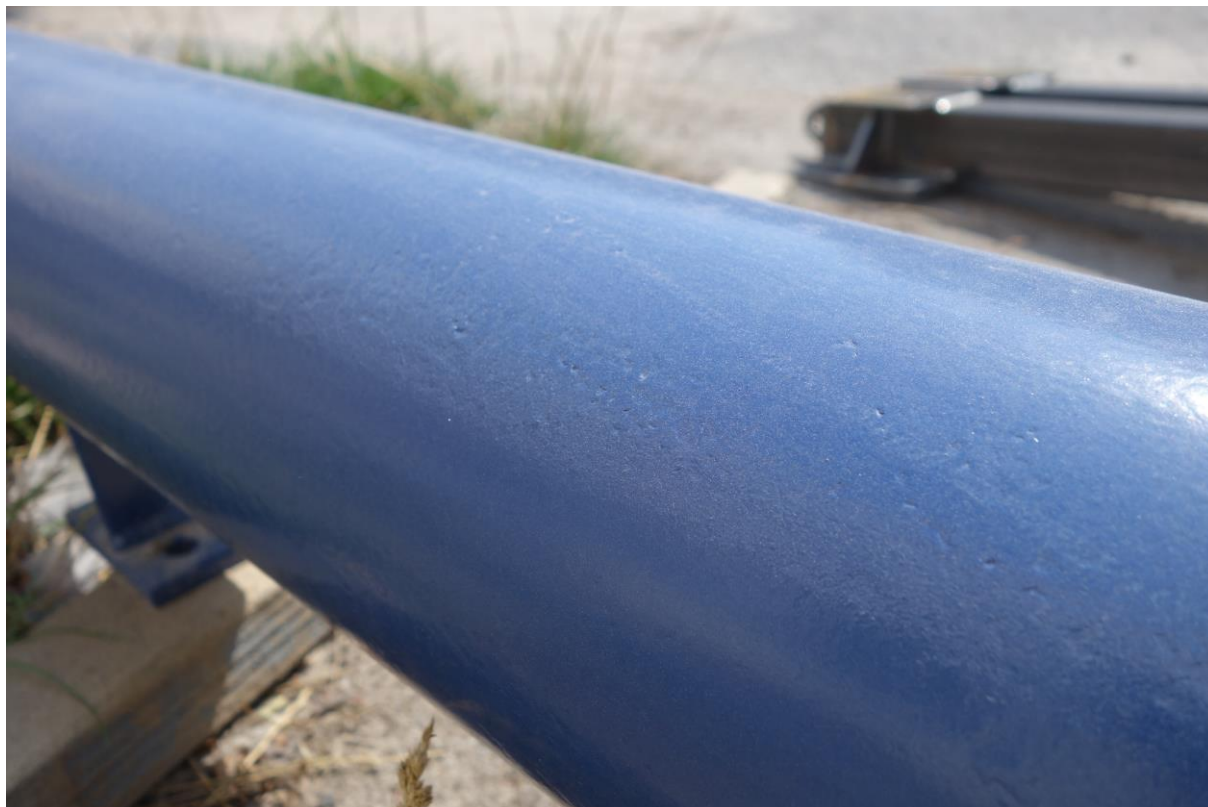
Obr. č.3 povrch trubkového madla s vyhovujícím zkušebním povrchem
