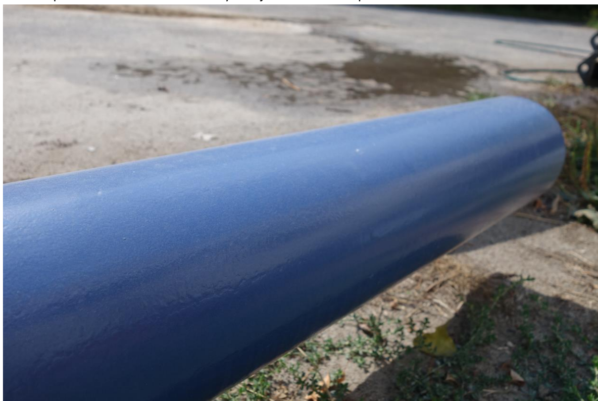
Obr. č.2 povrch trubkového madla s vyhovujícím zkušebním povrchem
