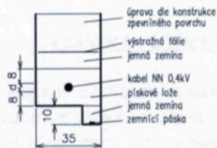
ŘEZ - U1 (kabelové vedení + uzemnění)
