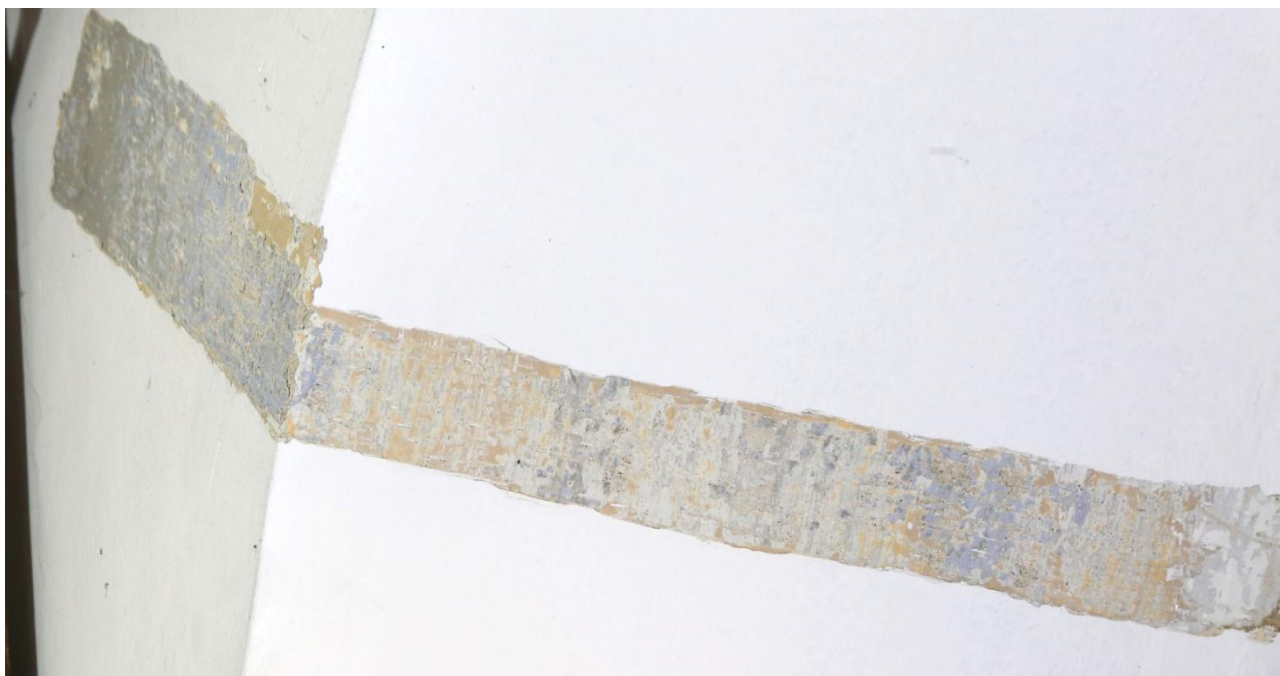
sonda K/4- jižní stěna kůru,1)- hrubší tmavě šedá vápenná omítková vrstva s výmalbou v šedě modrých odstínech, 2),3) - mladší hlinkové výmalby
