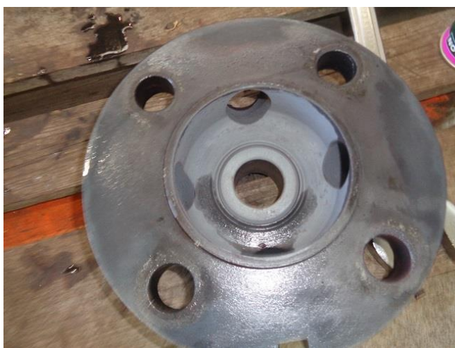
5.5 Píst – bez závad, stopy mírného zadírání přeleštit filcem na soustruhu
