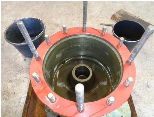
5.5 Píst – bez závad, stopy mírného zadírání přeleštit filcem na soustruhu
