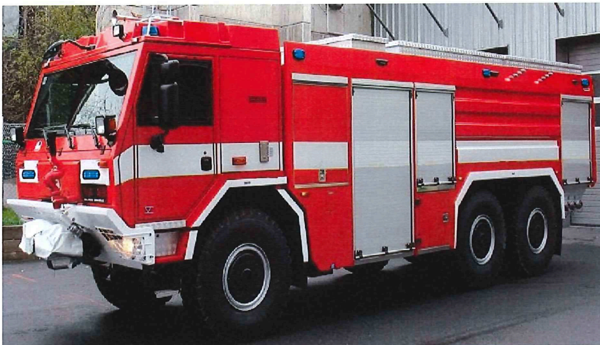
Obr. č. 1 – Koncepce nástavby, rozmístění pracovního osvětlení, světelných stavoznaků a světelného výstražného zařízení
