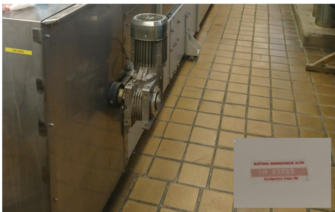
Položka č. 1 Pás navážecí zalomený s vážícím systémem, pohon a evidenční číslo
