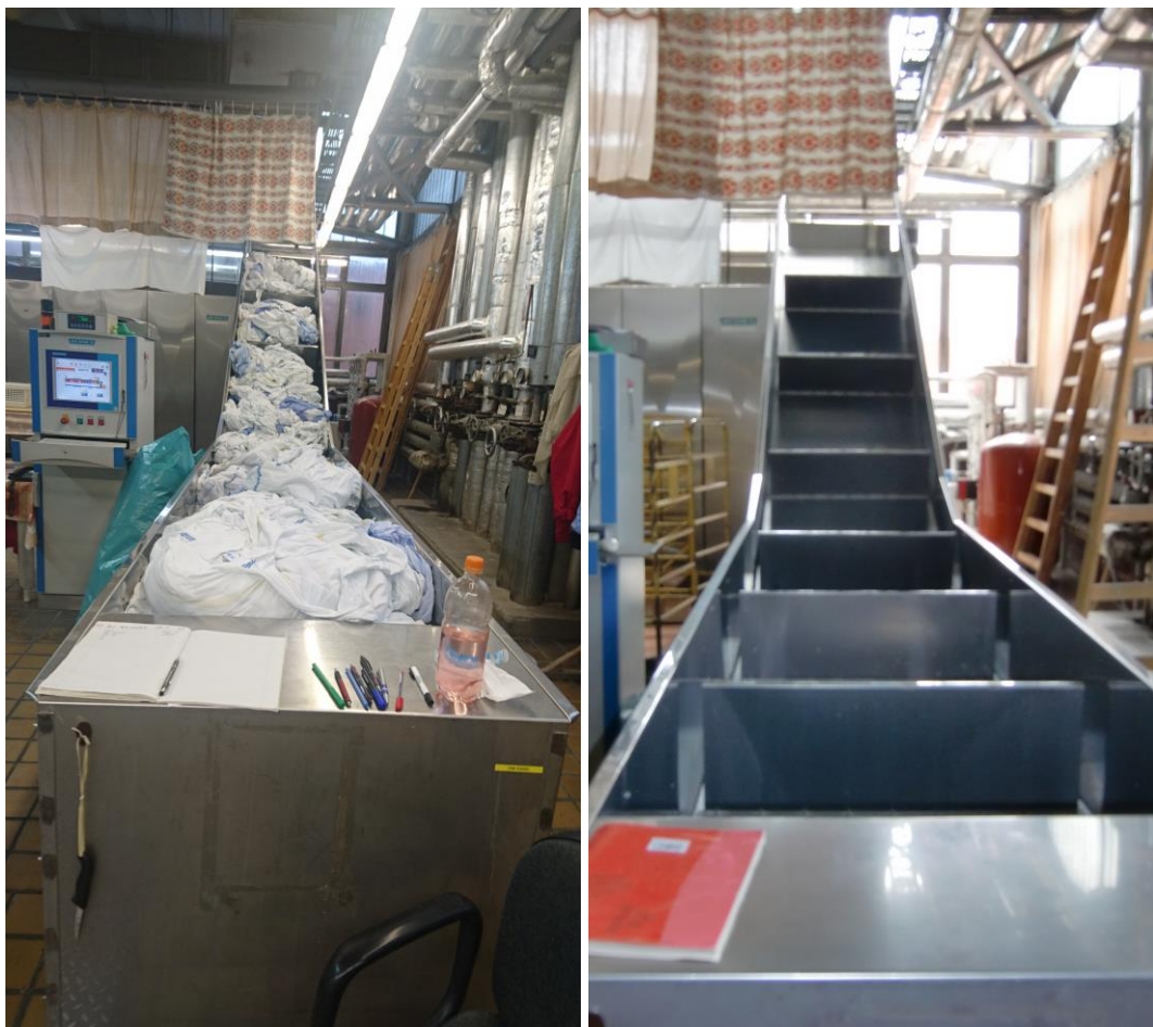
Položka č. 1 Pás navážecí zalomený s vážícím systémem, pohon a evidenční číslo
