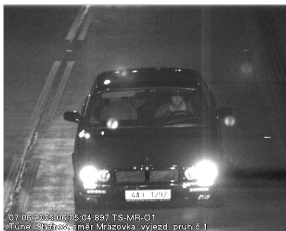
obr. 8: Snímek RZ vozidla jedoucího rychlostí 156,4 km/hod pořízený v noci. vozidla jedoucího rychlostí 156,4 km/hod. obr. 9: Snímek masky a obličeje řidiče téhož rychlostí 156,4 km/hod pořízený v noci. vozidla jedoucího rychlostí 156,4 km/hod.
