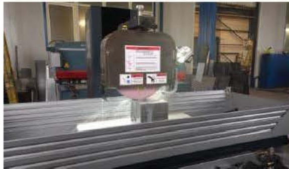
Broušení zkušebního kusu během školení obsluhy
