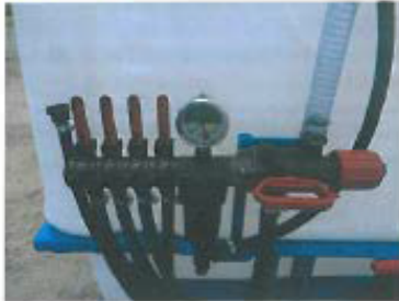
čerpadlo postřikovače 70l/min 20 bar
