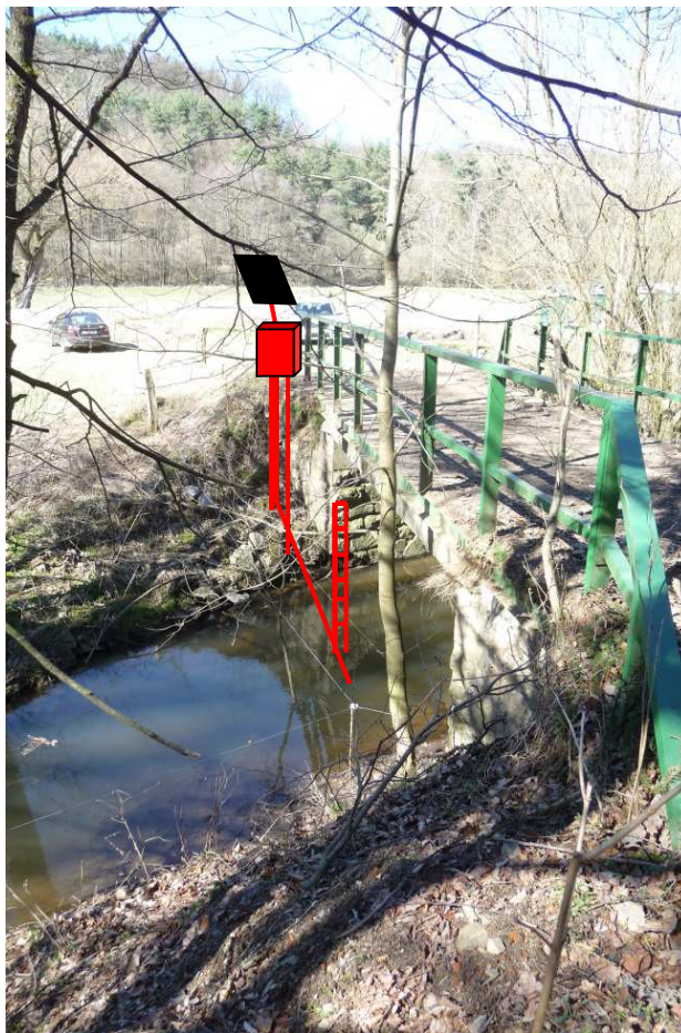
Obrázek 16 - Pohled na schematické umístění telemetrické stanice, tlakové sondy a vodočetné latě
