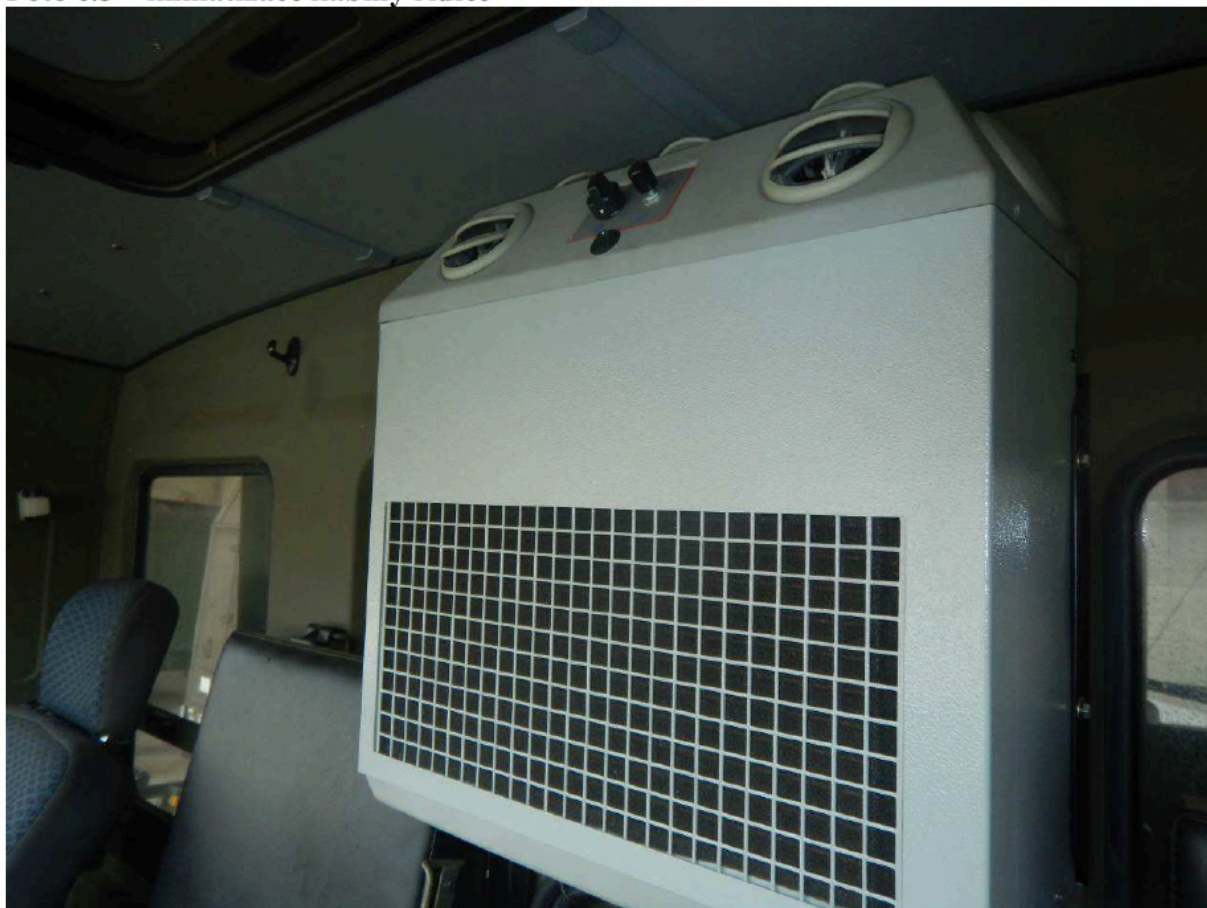
Foto č.5 – klimatizace kabiny řidiče
