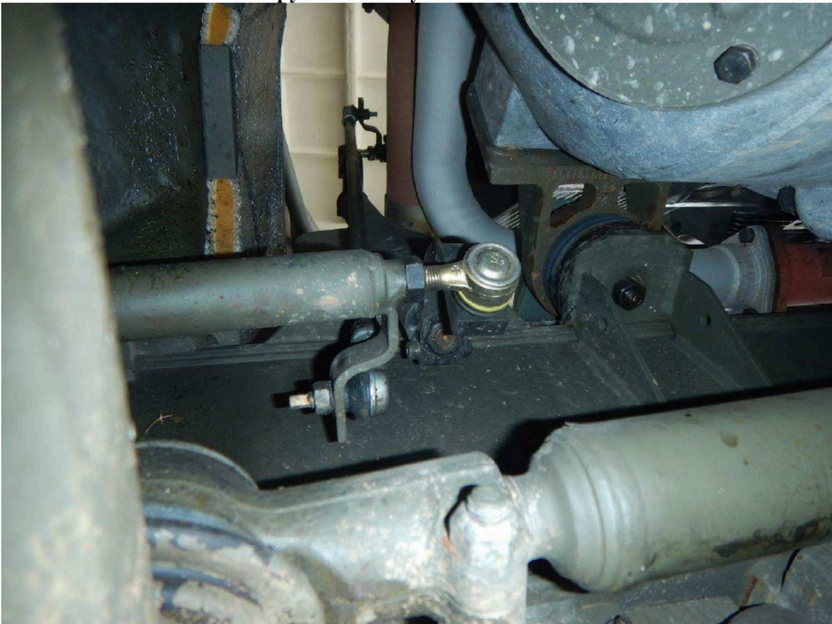
Ilustrační foto č.3 – kulové čepy řazení na výměnu
