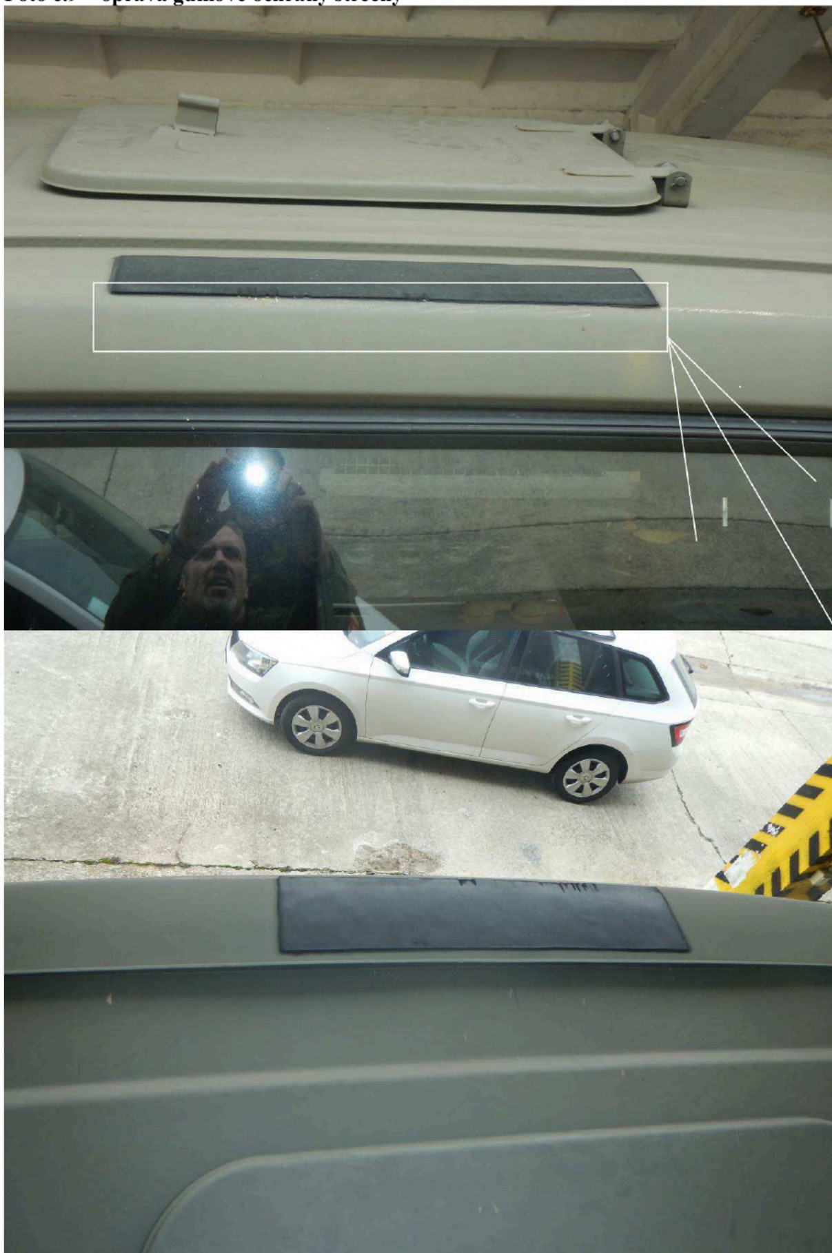
Foto č.9 – oprava gumové ochrany střechy
