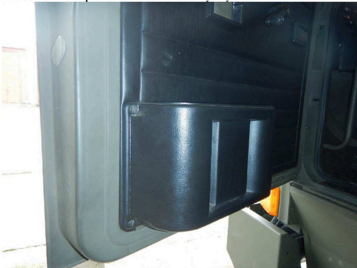
Foto č.7 – odkládací prostor ve dveřích řidiče nutný k výměně
