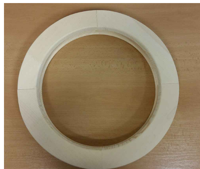
detail dřevěného rámu kruhového okna
