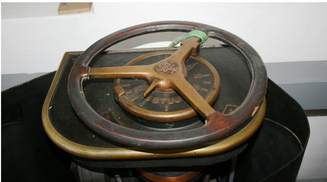
inv. č. 934/a,b kontrolér Křižík č. 13 s ovládacím volantem
