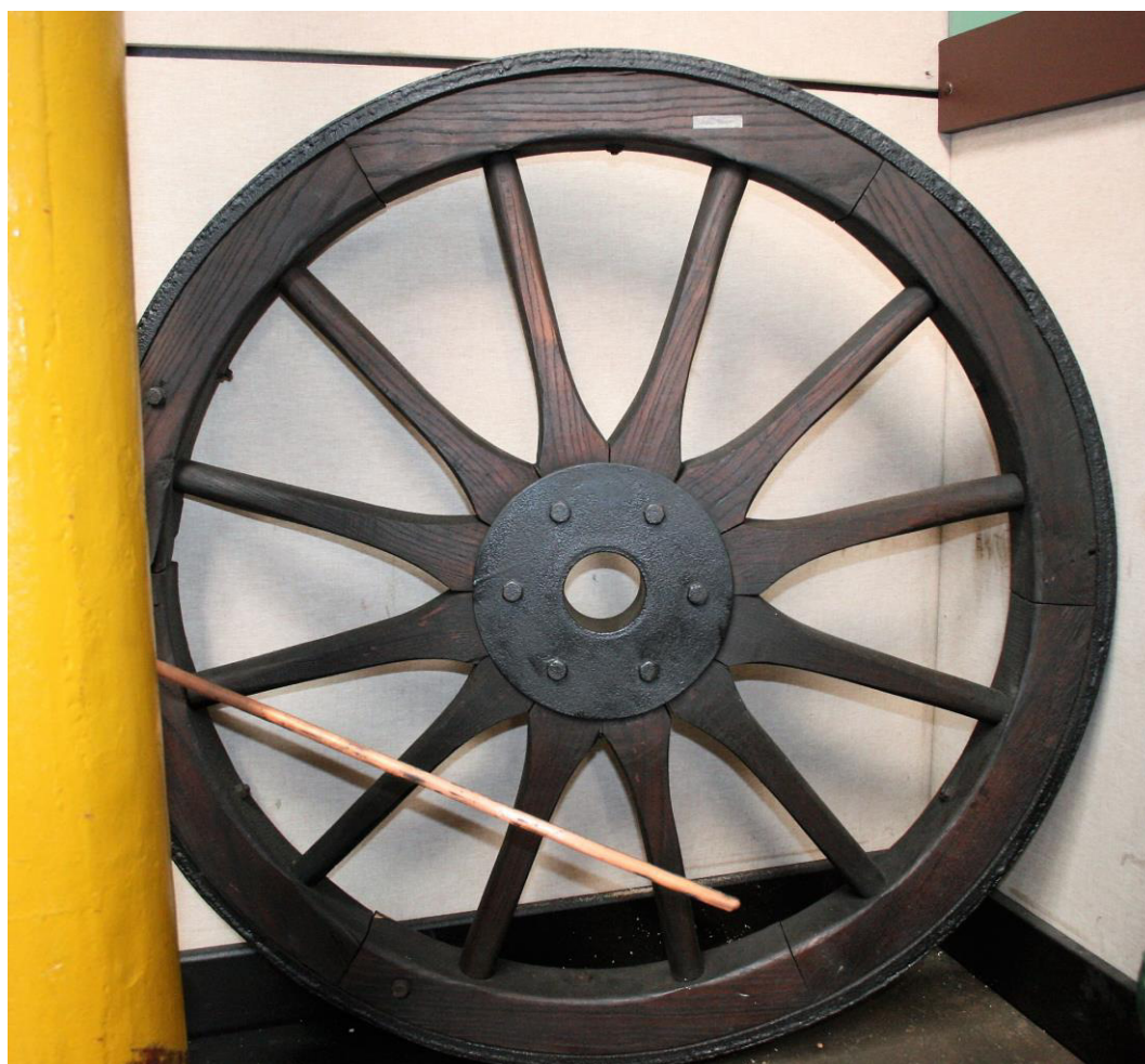
inv. č. 57852 loukoťové kolo koněspřežného montážního vozu EP pro jízdu ve žlábkové koleji
