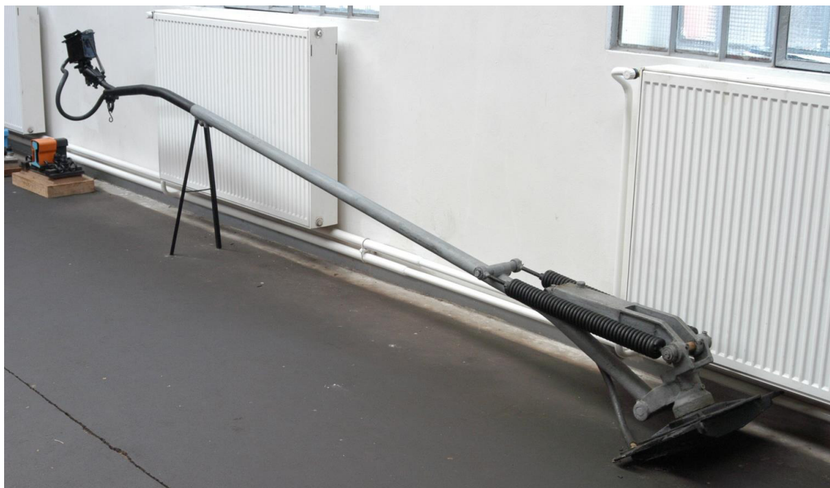
inv. č. 57850/a-d sběrače trakčního proudu a jejich součásti (4 ks)
