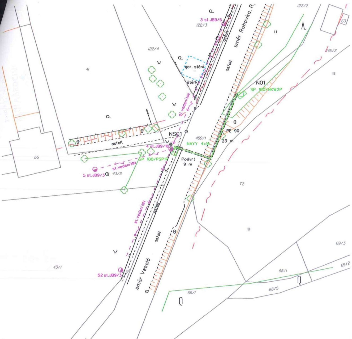
Situace vč.stávajících podzemních sítí ( M 1:500) :
