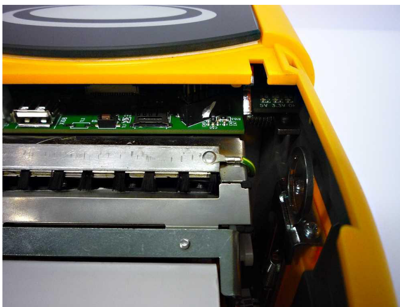
Obrázek 16: Optické indikátory stavu napájení - indikátor vnitřního napájení 5 V vlevo, indikátor vnitřního napájení 3,3 V uprostřed a stavový indikátor OK vpravo
