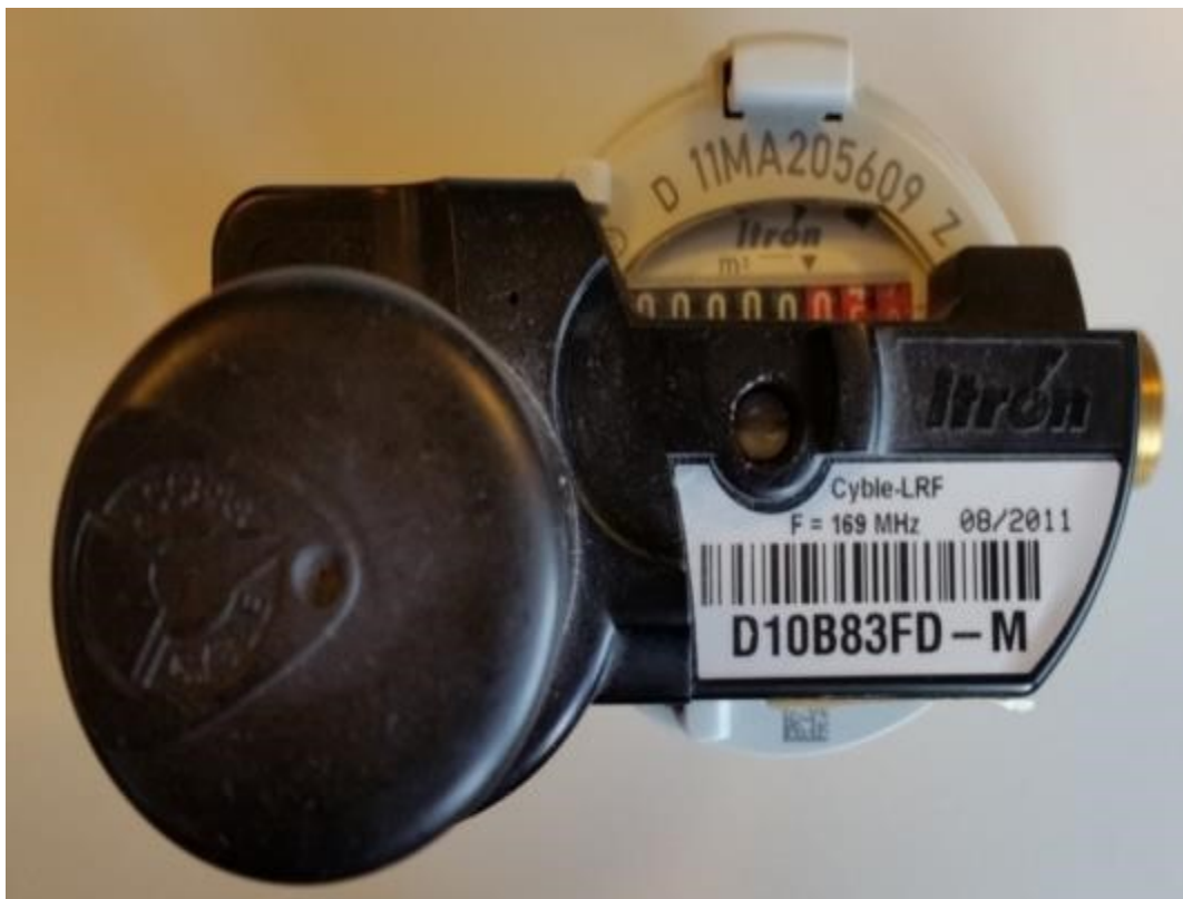
Vodoměr osazený senzorovým snímačem
