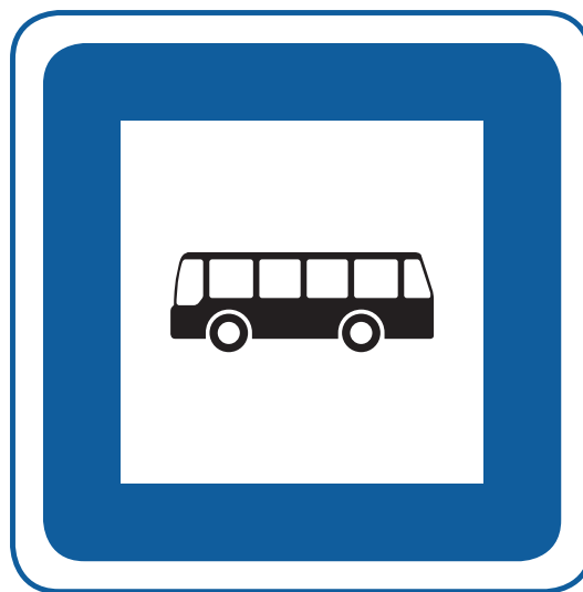
Dopravní značení autobusové zastávky
