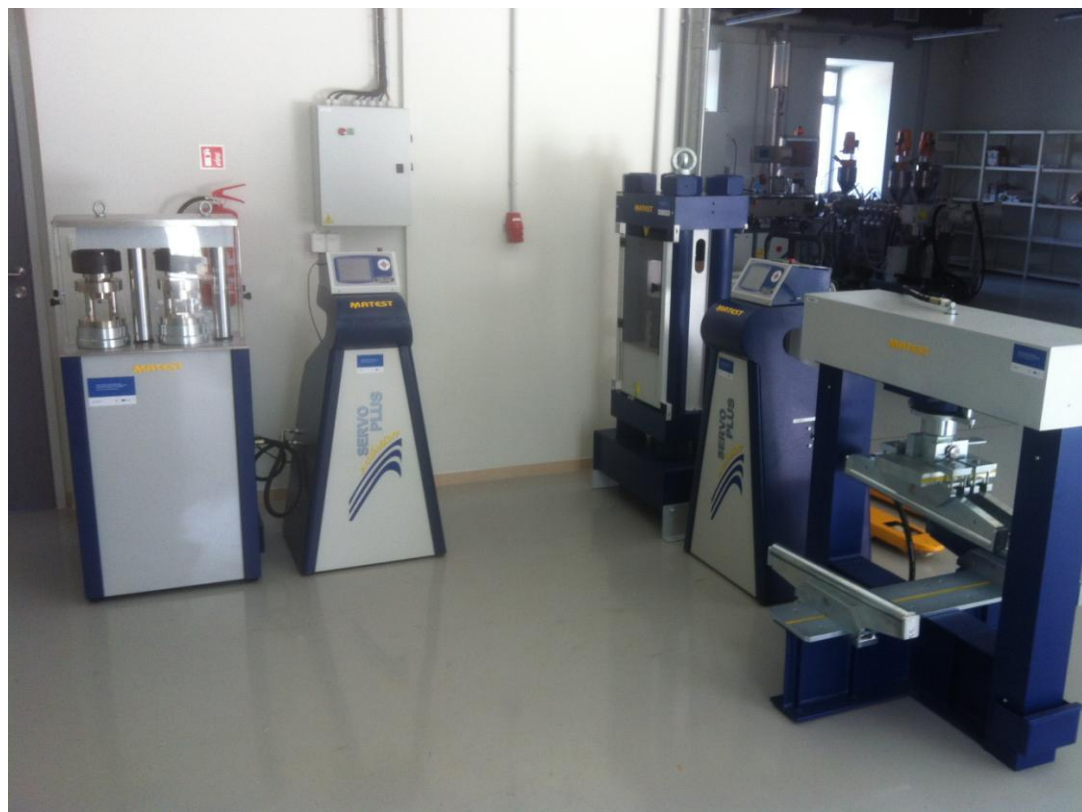
Instalované zkušební lisy Matest (Technopark, VŠCHT)
