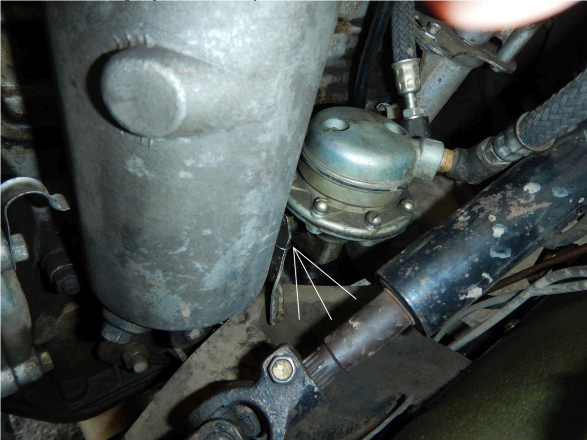
Foto č. 2 – únik oleje z podávacího čerpadla
