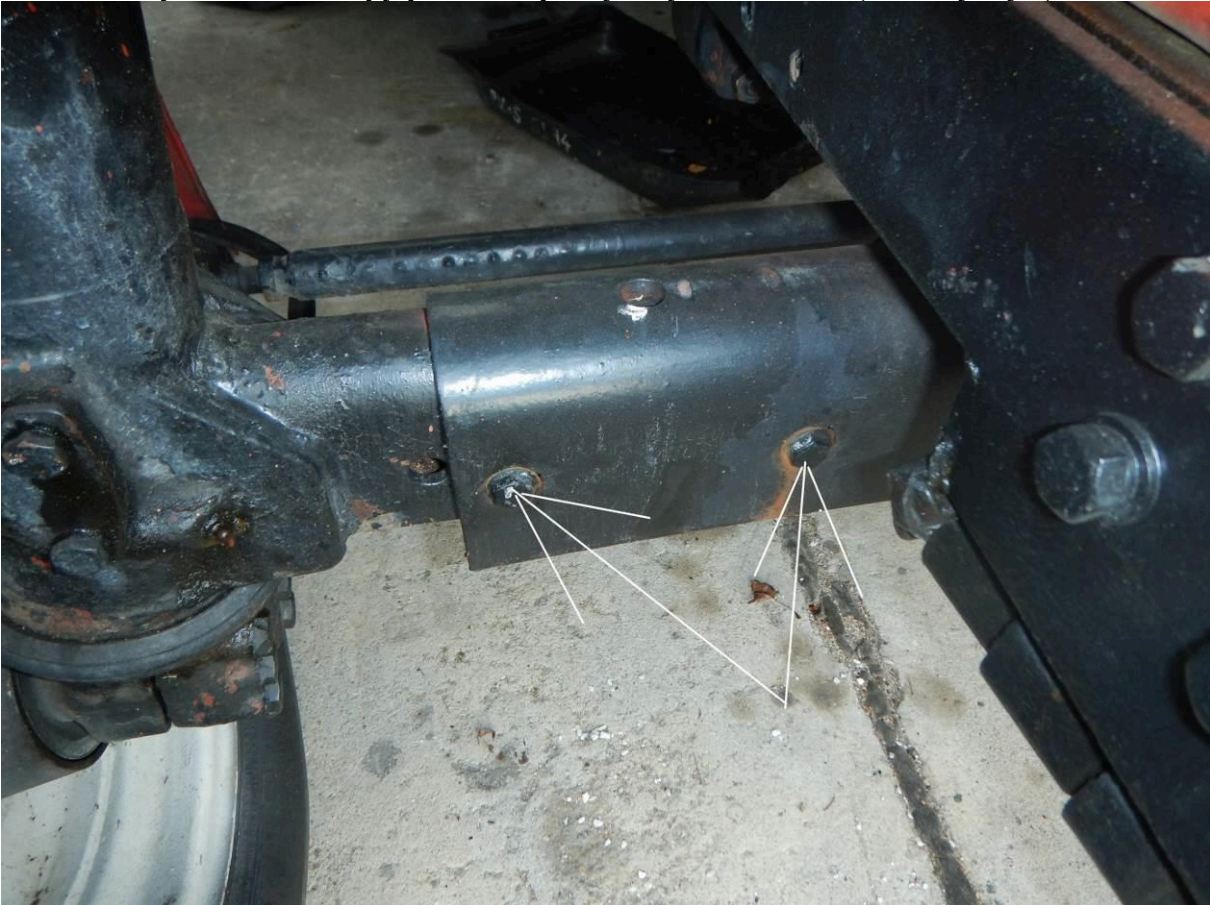
Foto č.6 – upevňovací šroupy přední nápravy – výměna – vůle (všechny čtyři)
