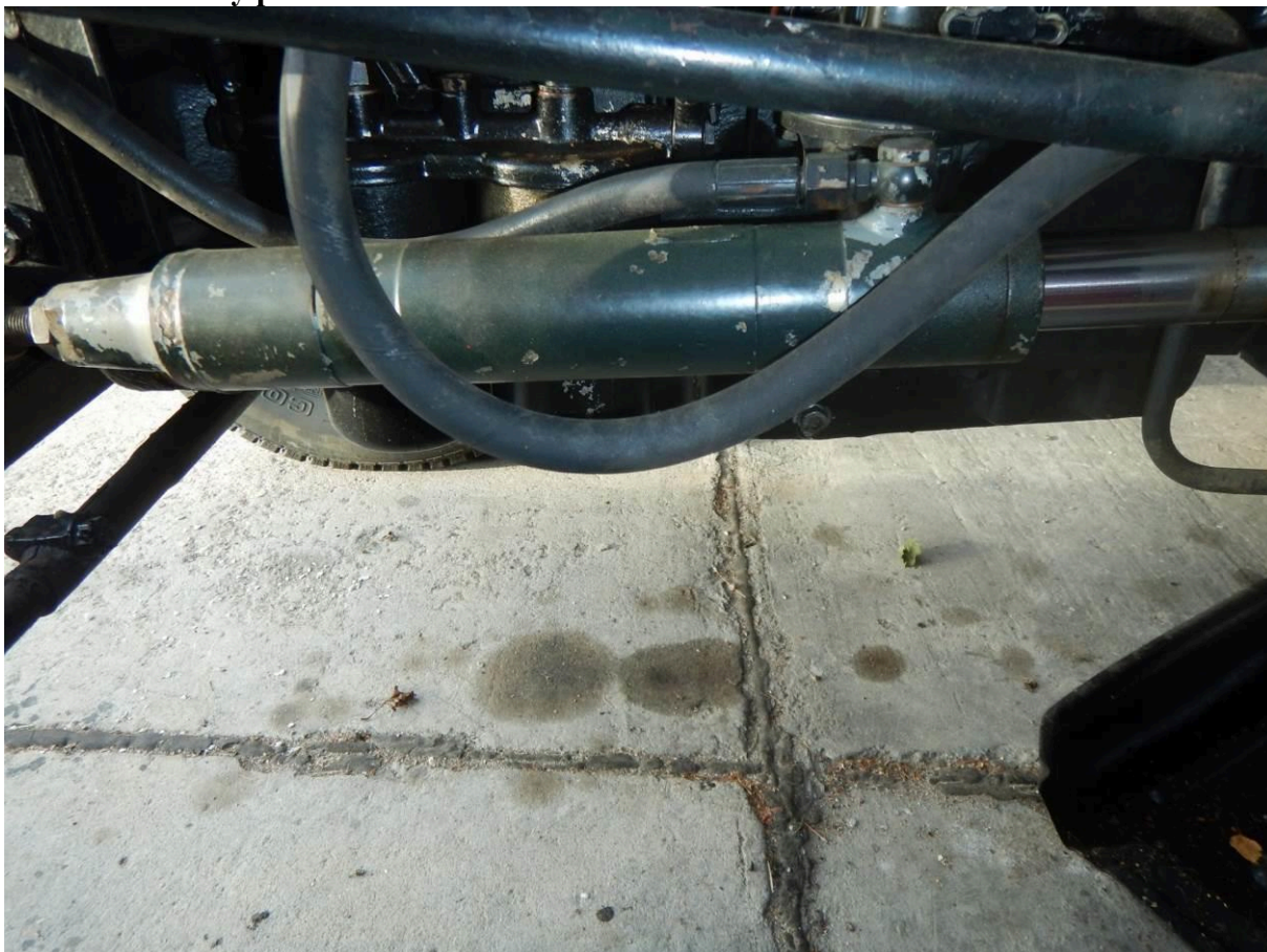
Foto č. 2 – vadný posilovač řízení
