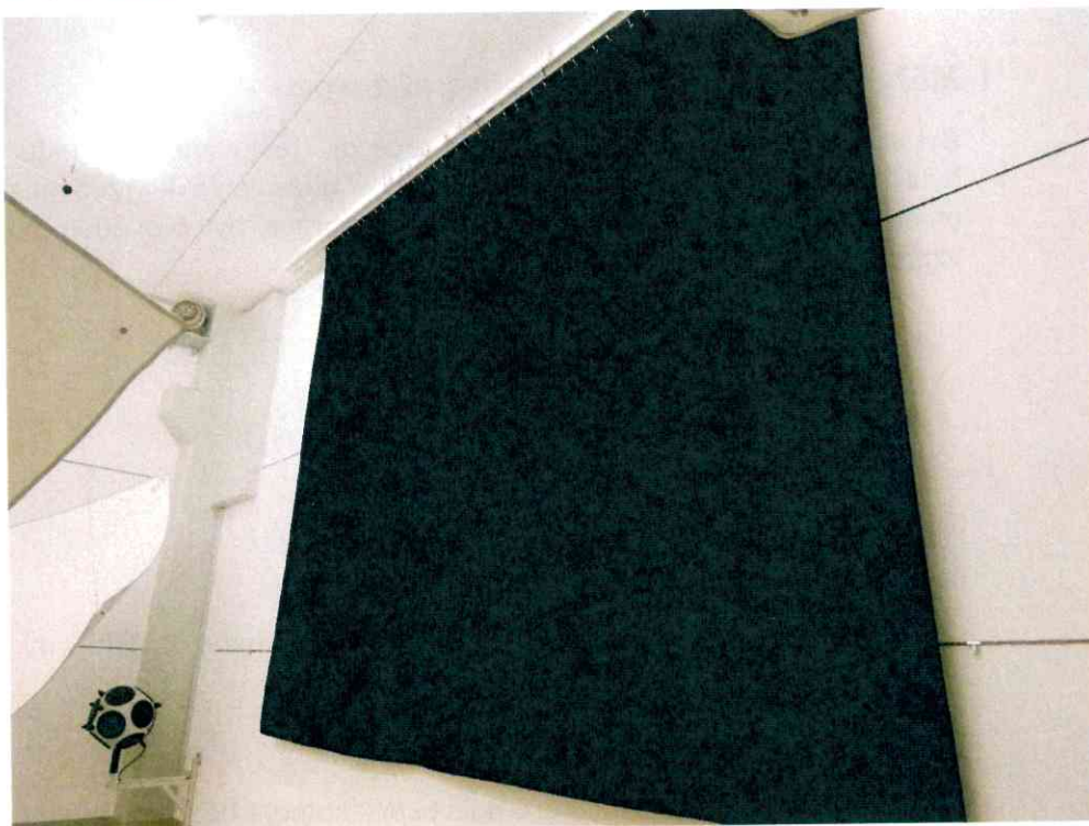
Obrázek B.1. Záclona v odrazové místnosti, volně zavěšená.
