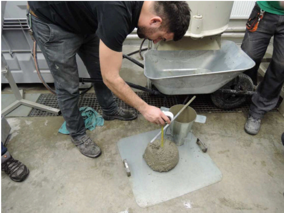
(1) Obr. 1 – Sednutí kužele – správné zhutnění, rovnoměrně sednutý kužel
