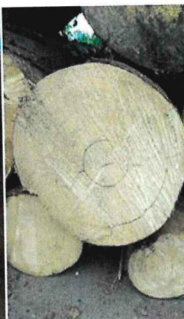
Odlupčivá trhlina – dovoľuje sa
