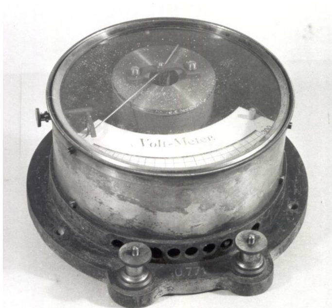
Rozvaděčový voltmetr 0-300 V, syst. Hummel
