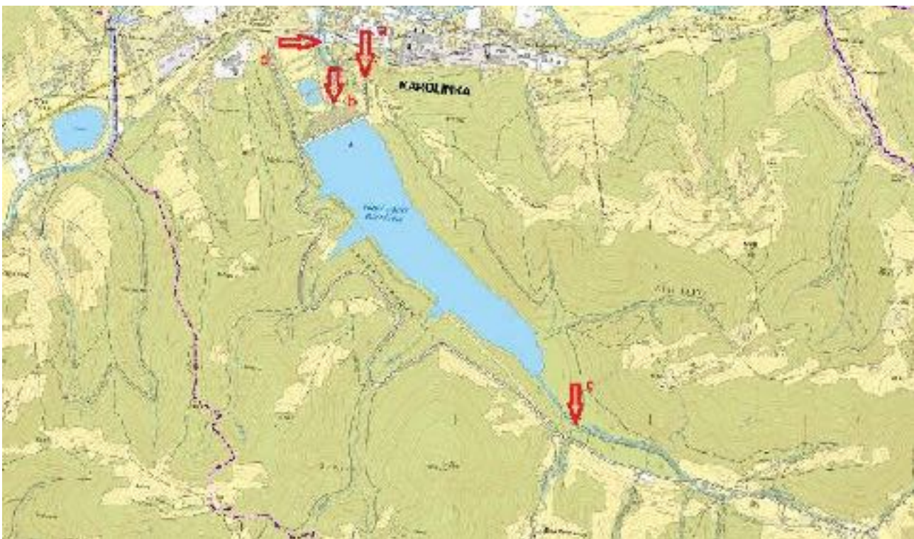
Situační plán VD Karolinka – a) dům hrázného, b) strojovna spodních výpustí, c) limnigraf na přítoku, d) limnigraf pod hrází
