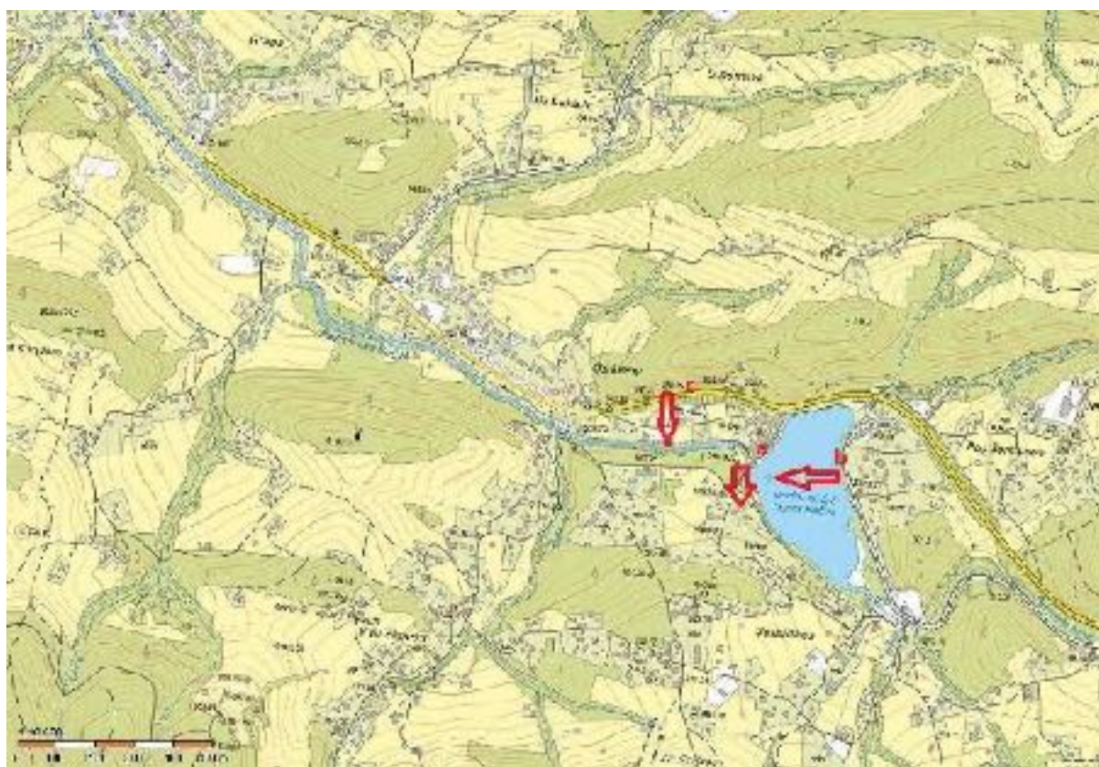
Situační plán VD Horní Bečva – a) dům hrážného, b) strojovna spodních výpustí, c) limnigraf pod hrází
