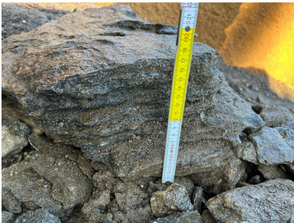
Obrázek 5. Blokovitost amfibolitu ve III. třídě těžitelnosti.
