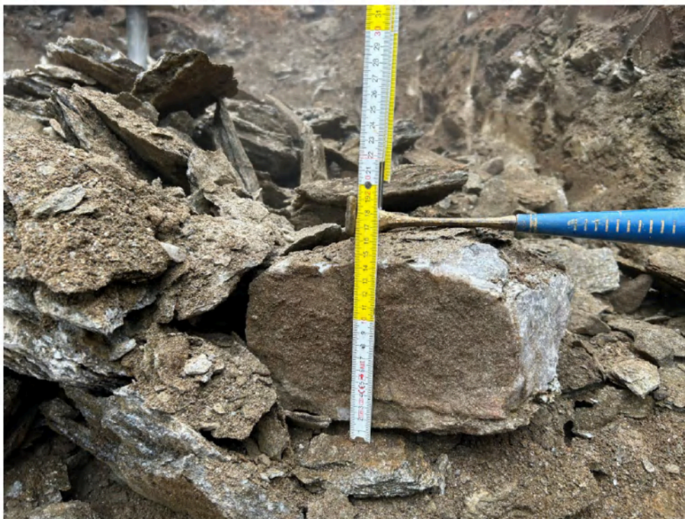
Obrázek 4. Vzdálenost diskontinuit amfibolitu ve III. třídě těžitelnosti dle ČSN P 73 1005.
