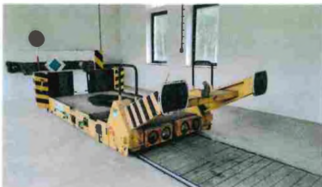
Příloha č. 1: Fotodokumentace posunovacího zařízení
