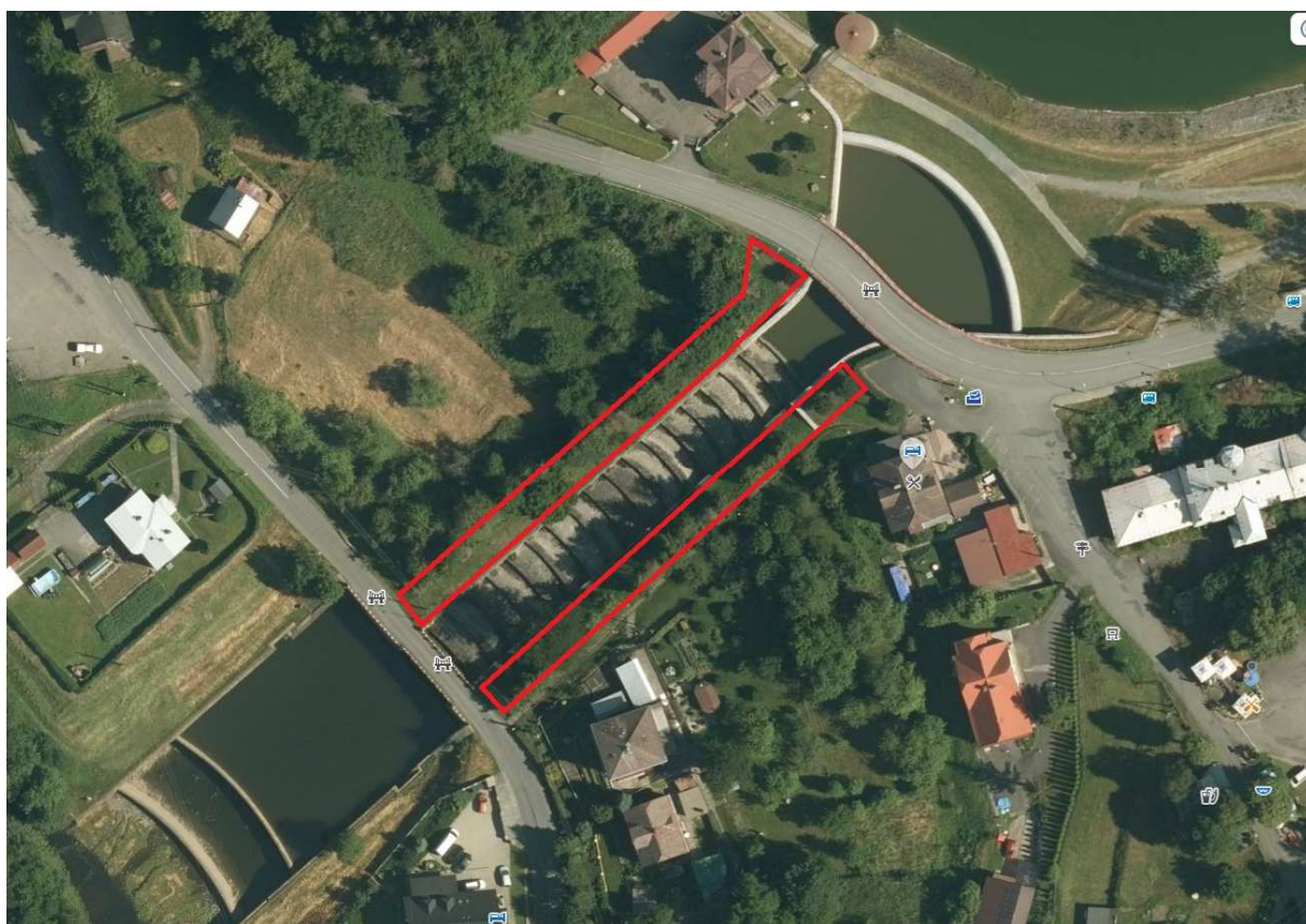
Kaskády bezpečnostního přelivu
