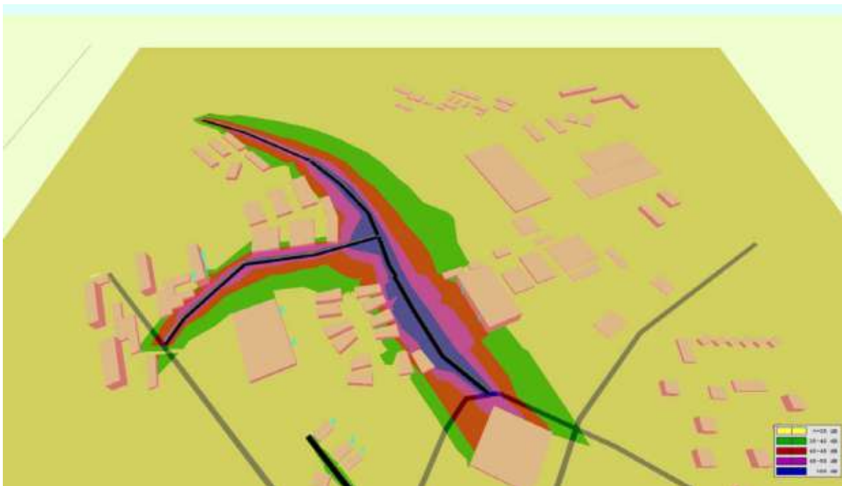
Obr.: Grafické znázornění výpočtového modelu - hluk z pozemních komunikací - budoucí stav - znázornění pásem izofon 1
