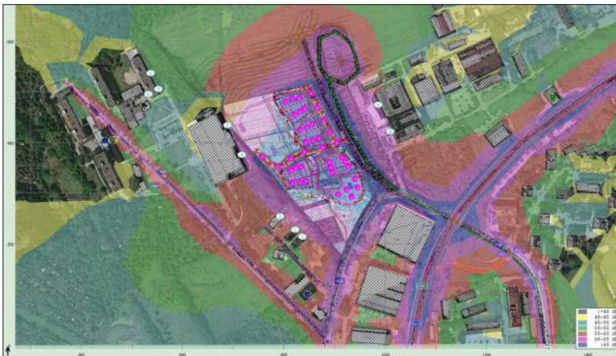
Obr.: Grafické znázornění výpočtového modelu – hluk ze stavební činnosti – zemní práce DEN - znázornění pásem izofon 1
