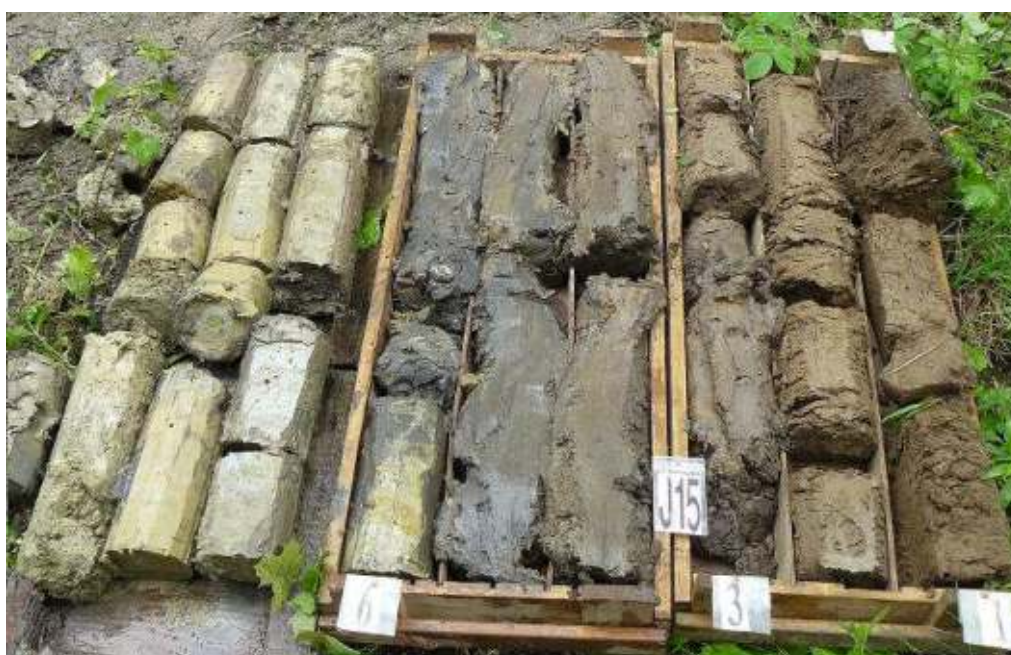
Obr.6 – Vrt J15, metráž 0,0 – 10,0 m (v int.9,0-9,8m ztráta jádra)
