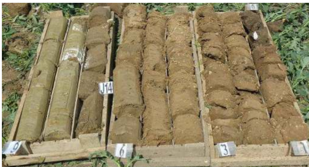
Obr.5 – Vrt J14, metráž 0,0 – 9,0 m
