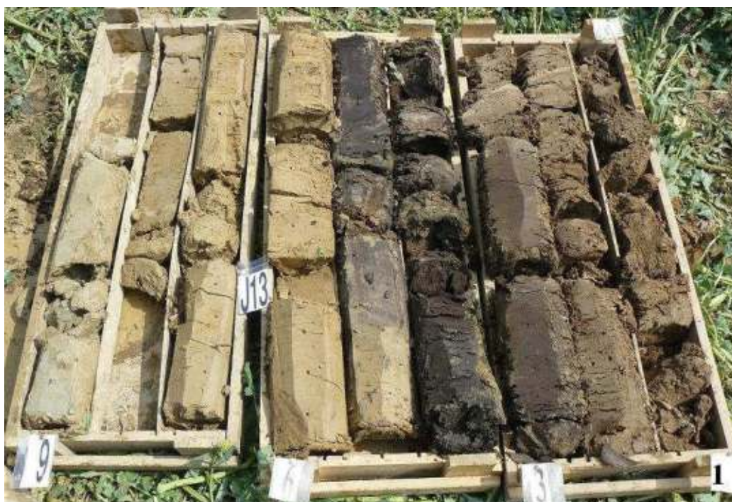
Obr.4 – Vrt J13, metráž 0,0 – 9,0 m
