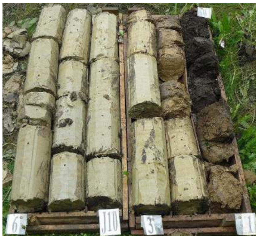
Obr.1 – Vrt J10, metráž 0,0 – 6,0 m
