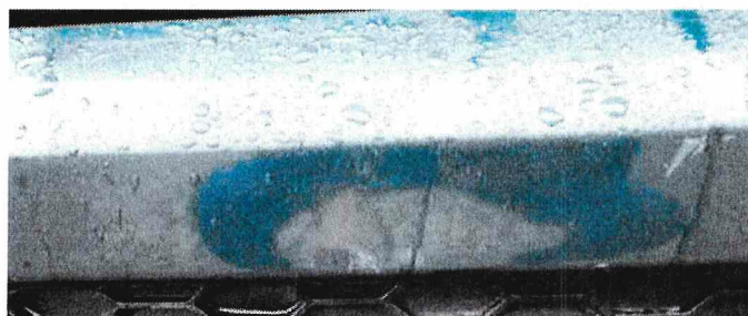
lak zadního nárazníku poškozen
