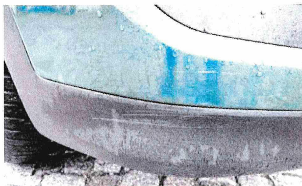
lak předního nárazníku poškozen, plasty nárazníku poškrábány
