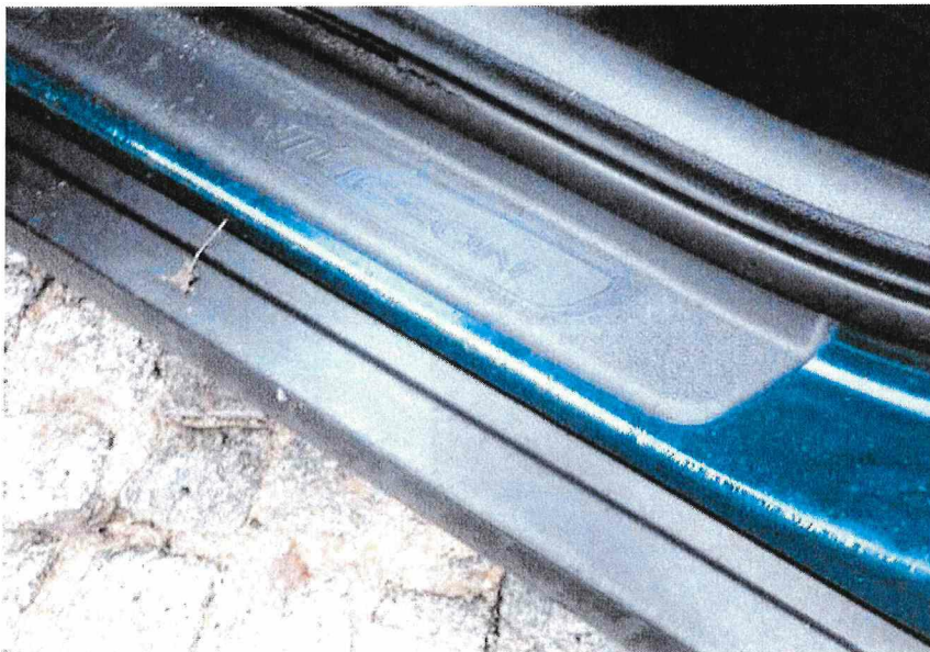
obvodové těsnění dveří poškozeno, plasty interieru poškrábány, lak vnitřního prahu poškozen
