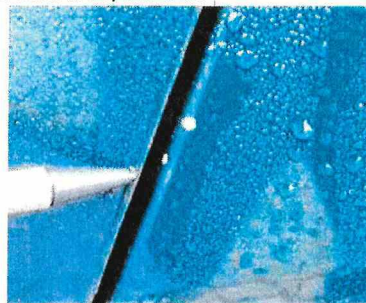
lak levého zadního blatníku poškozen
