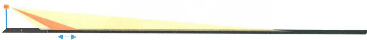
Obr. 1 Měření okamžité rychlosti (na krátkém úseku)
