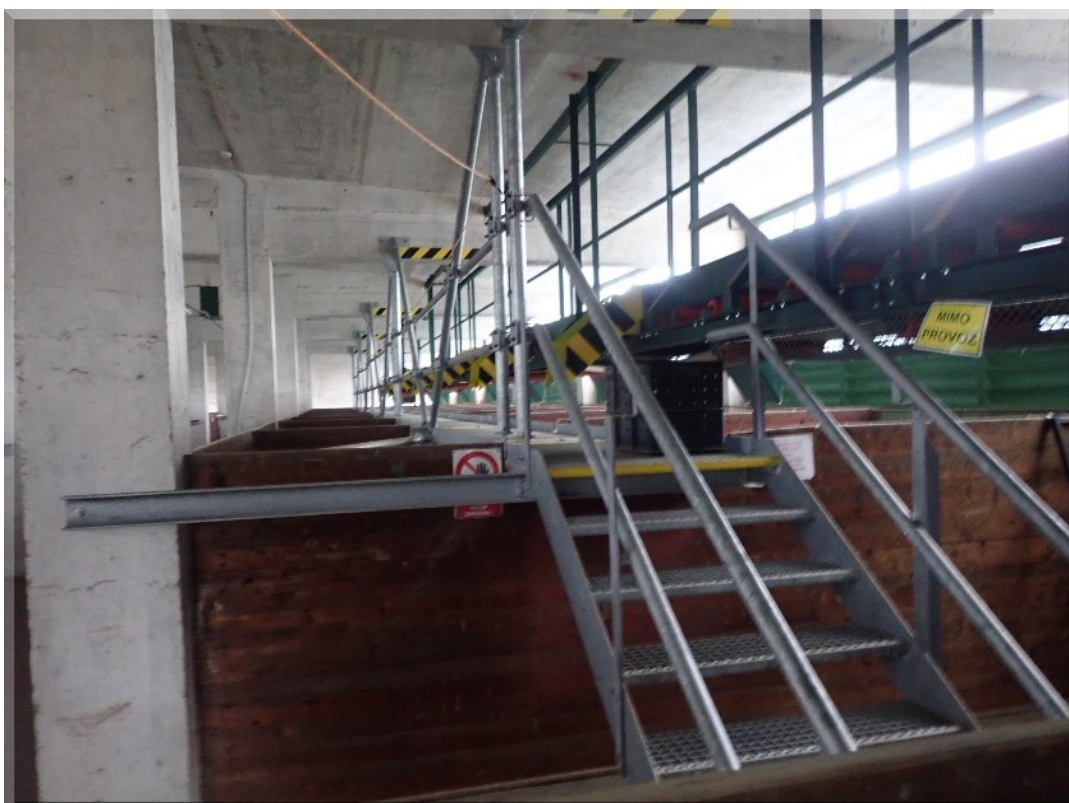
Foto PB266101: 02-c - sklad šišek - obslužné lávky u pásových dopravníků (5. NP, cca 150 m)
