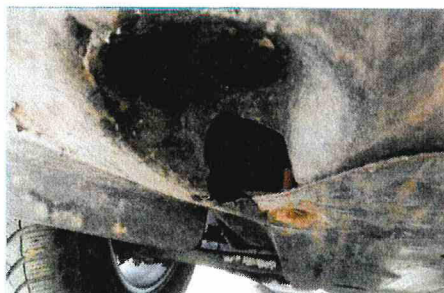
foto č.16, 17 – pohled na poškozené kryty podvozku
