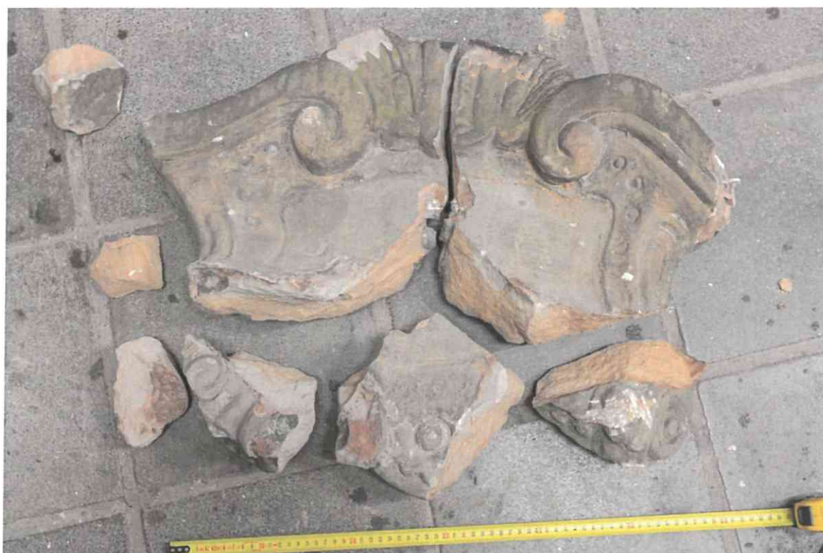
Největší kusy rozlámané kartuše. Kromě jiného jsou na úlomku v pravém dolním rohu viditelné stopy po opakovaných úderech, které zřejmě také vedly k rozlomení kartuše..
