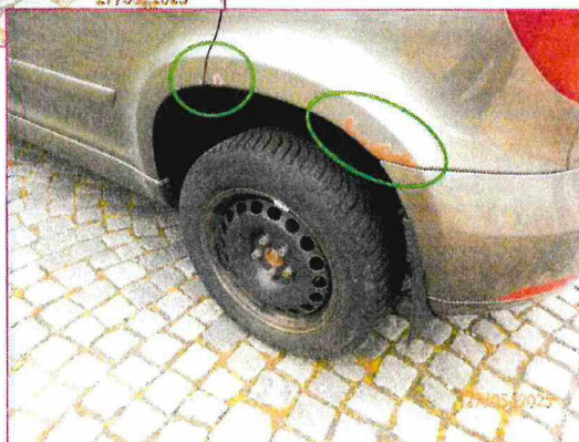
foto č. 16 – pohled na korozi LZ blatníku
