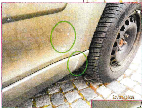
foto č. 15 – pohled na poškozený lak LZ dveří
