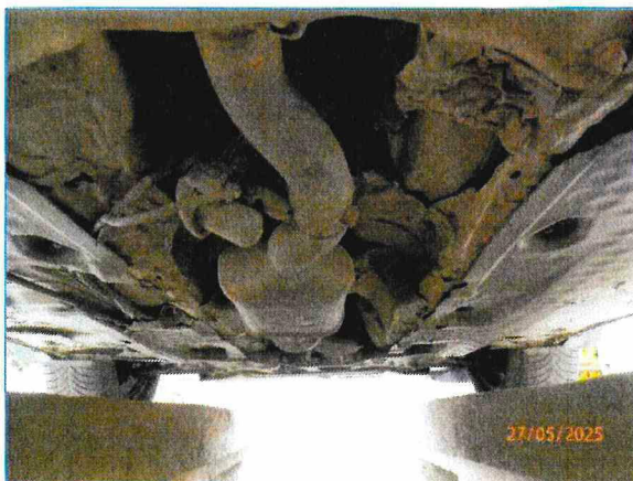
foto č.18 – pohled na poškozené plast. kryty podvozku
