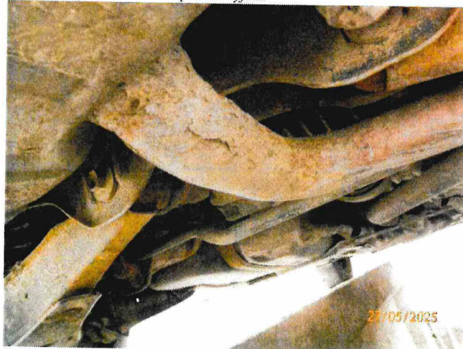
foto č.21 – pohled na korozi potrubí výfuku
