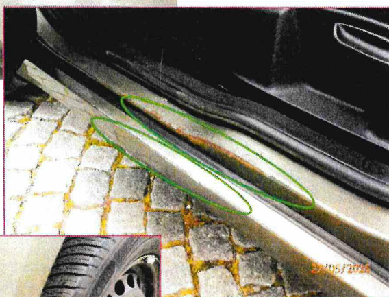
foto č. 15 – pohled na poškozený lak LZ dveří
