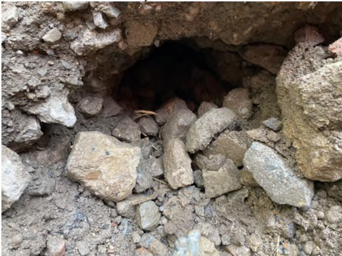
Příloha C – Úlomky betonové suti ve vrtném kanálu
