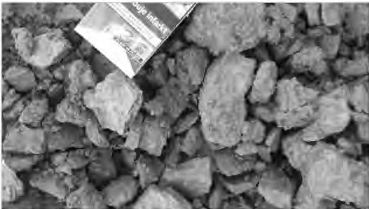
Obr. 10 Mírně zvětralý jemnozrnný pískovec z hloubky 5 m pod terénem. Jedná se již poměrně pevnou horninu, která se při rozpojování rozpadá na ostrohranný štěrk.
