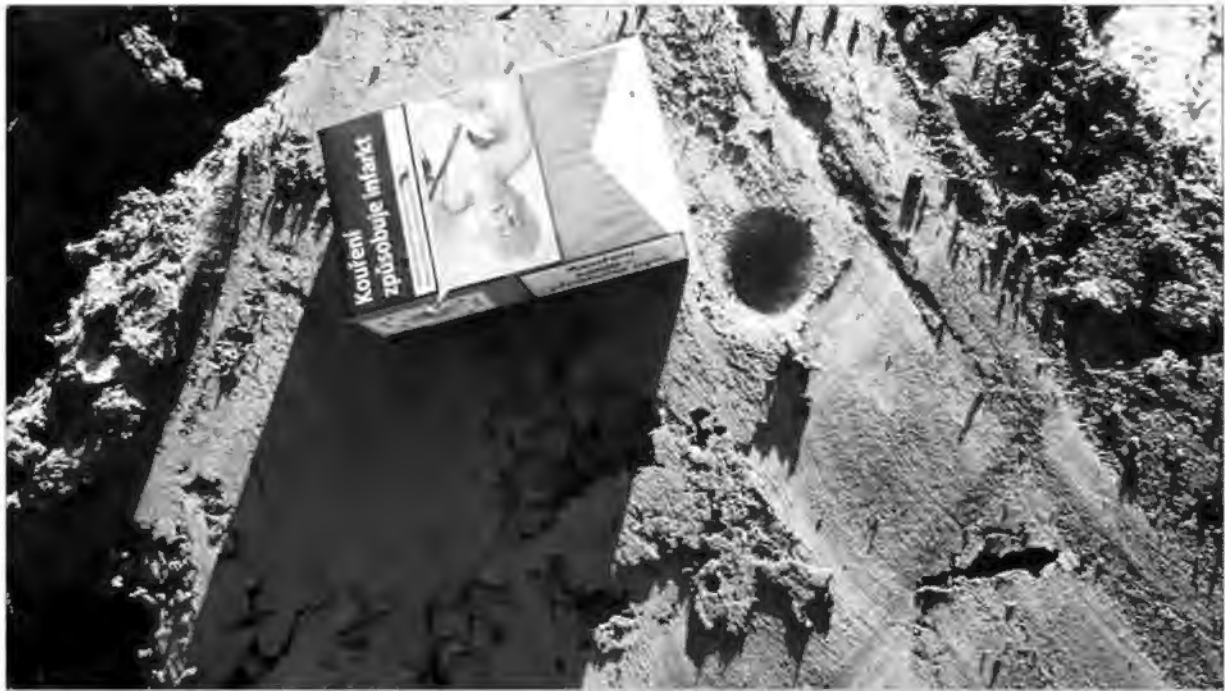
Obr. 7 Plastický jíl tuhé konzistence ze sondy SČB-1. Vedle cigaret je otisk vřáčeného palce.
