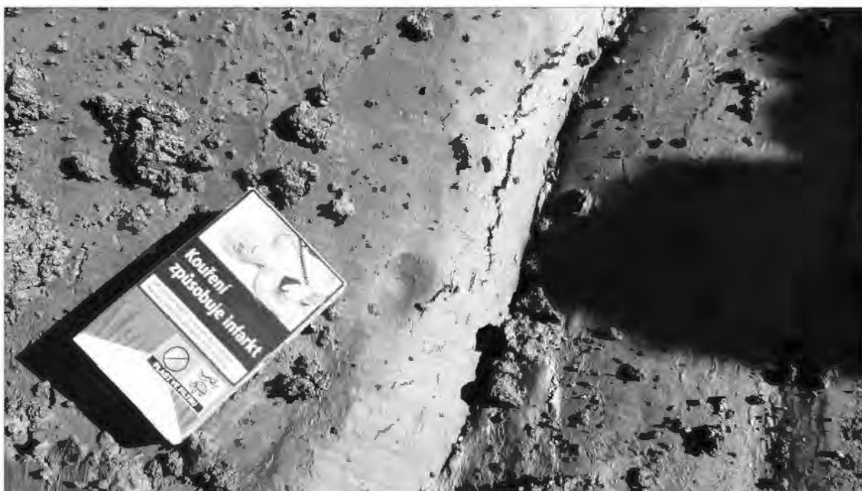
Obr. 8 Prachovitý jíl pevné konzistence.
