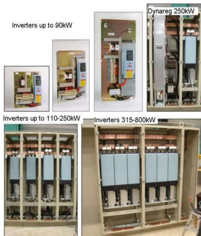
Obrázek 3. Rodina DynA se skládá ze střídačů do 1,5 MW. Jednotky o výkonu 90 kW jsou kompaktního typu, kde jsou ovládací a napájecí prvky a další základní součásti sestaveny na stejném panelu. Větší jednotky jsou s posuvným lůžkem a řídicí jednotka je sestavena samostatně. Linka DC-bus je na vrcholu řady skříní.
