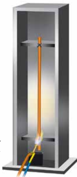
Zkouška svislého šíření plamene, samozhášivost
