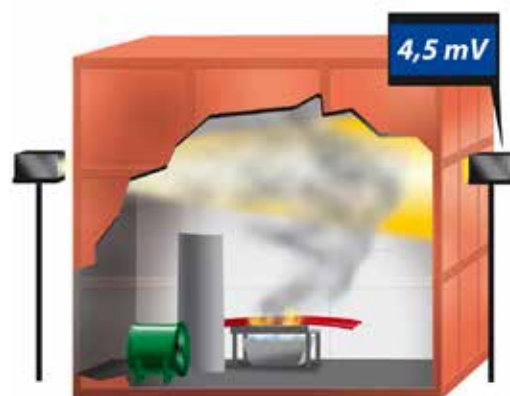
Měření hustoty kouře, kabely s min. hustotou kouře
