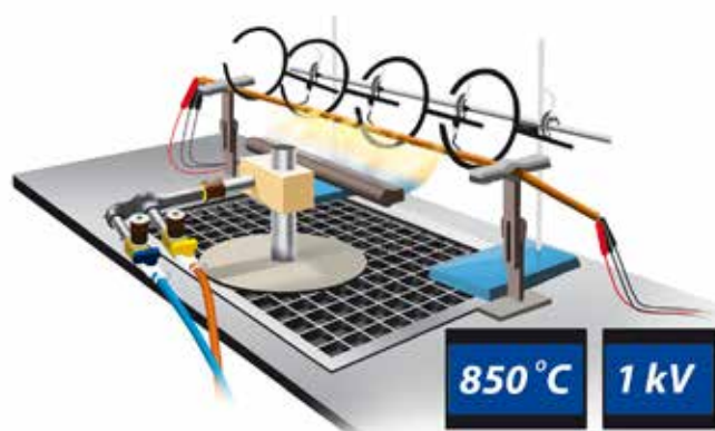
Zkouška podle ČSN EN 60331 (850 °C, 1 kV)
