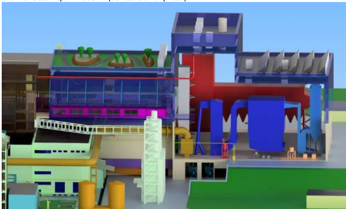
Obr. 10: Čištění spalin kotle K1 (bez stavebních příček)
