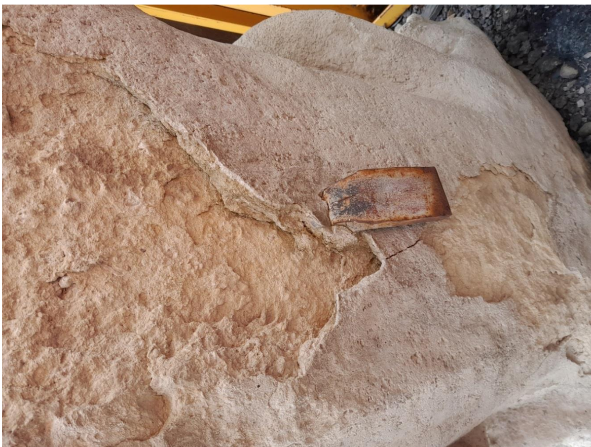
6,7) Zadní strana figury s hloubkovou degradací originální hmoty kamene.
