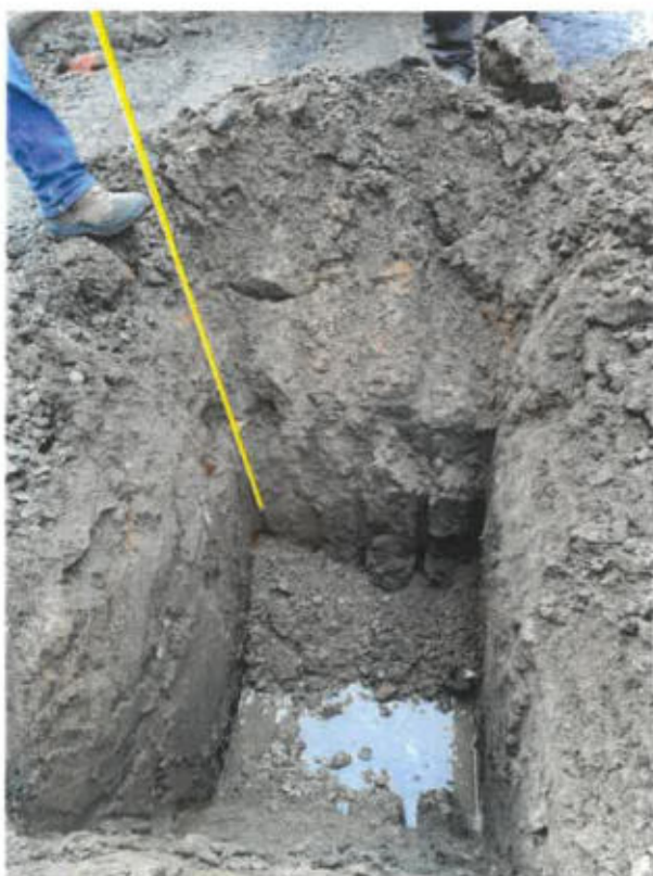
Obr. 2 Kopaná sonda KS2 (hl. 1,4 m)
